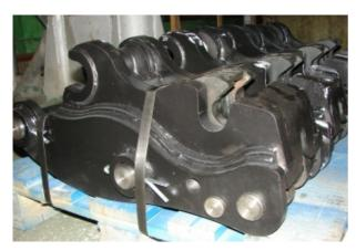
Квик-каплер - элемент соединения различных частей строительного оборудования, позволяющее произвести быстрое снятие (установку) навесного оборудования.
