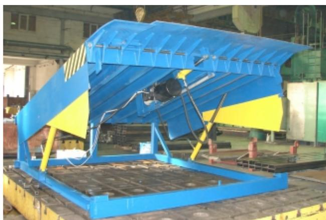
Перегрузочное оборудование, такое как доклевеллер, выравнивающие платформы применяется там, где необходимо иметь надежное, простое в эксплуатации переходное устройство между полом помещения и поверхностью кузова автомобиля.
