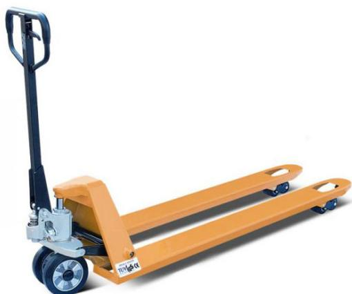
Тележка ручная гидравлическая "Универсал" предназначена для транспортировки груза, паллетированного или упакованного на поддоны, с помощью ручного управления. Использование тележки предусматривает работу на ровных и твердых поверхностях.
