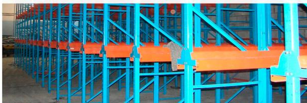
Жесткая конструкция набивных стеллажей состоит из металлических рам и специальных направляющих, образующих тоннели, в которых размещаются деревянные паллеты с грузом. Стеллажи конструктивно сложнее, чем фронтальные, они позволяют намного эффективнее использовать всю площадь склада — такими конструкциями можно занять около 80 процентов свободного пространства. Высокая компактность достигается при помощи уменьшения количества дорожек между стеллажами. Погрузчики проходят прямо в каналы системы.
