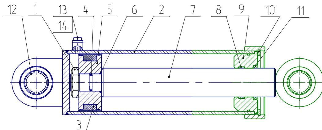
**Рис. 5 Гидроцилиндр НС**
