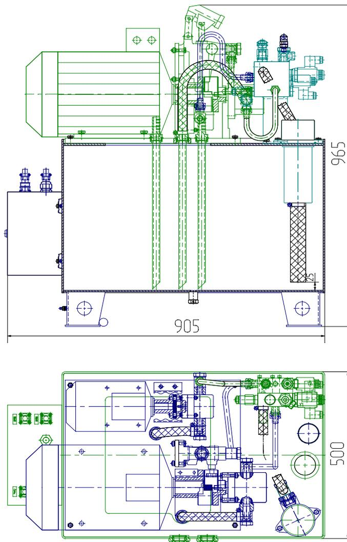
**Рис 11 Гидростанция для стола с гидроцилиндрами оснащенными гидрозамками**
