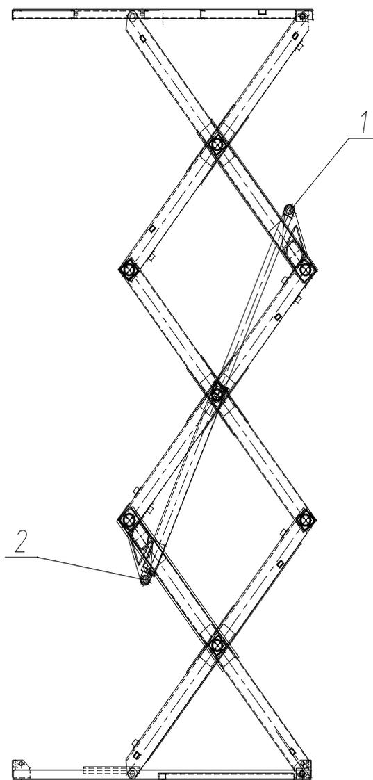
Рис 20 Схема смазки
