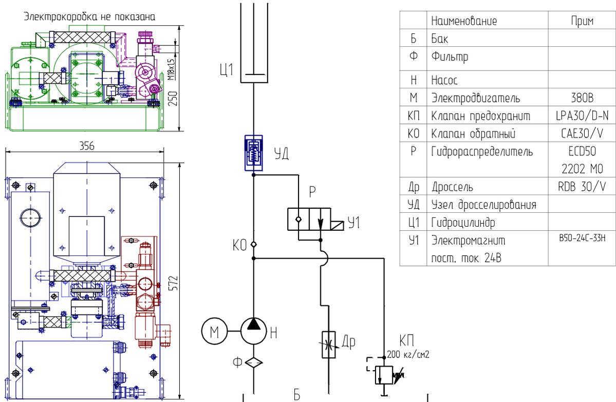
Рис 9 Встраиваемая гидростанция и схема гидравлическая принципиальная
